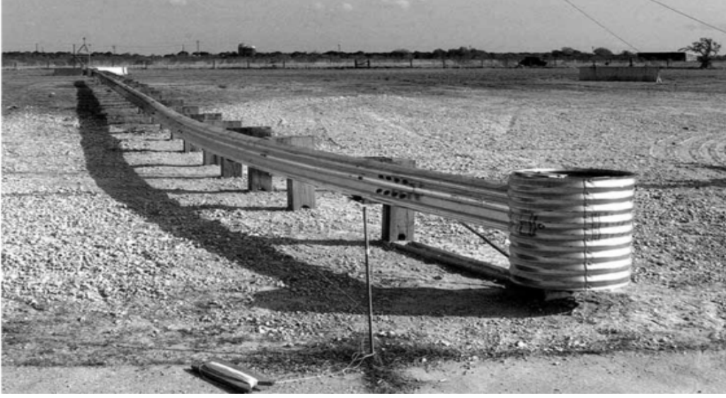
Şekil 6: Tescilsiz Eksantrik Yükleyici Sonlandırıcı (ELT) [10]
