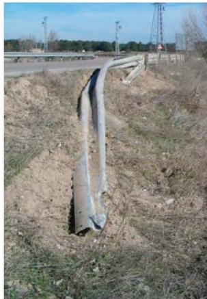
Şekil 14: Sonlandırıcının ilk birkaç dikmesine çarpılmasının sonuçları
